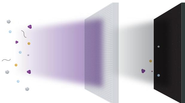
Органические и химические загрязнители адсорбируются на поверхности с нанесением  $TiO_2$ , под действием **ультрафиолетовых светодиодов** происходит инактивация: разложение на безвредные  $CO_2$  и воду, а **угольный фильтр** впитывает запахи и неразложившиеся химические элементы.
